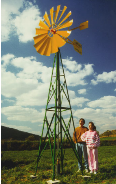
Molino de viento destinado al bombeo de agua
